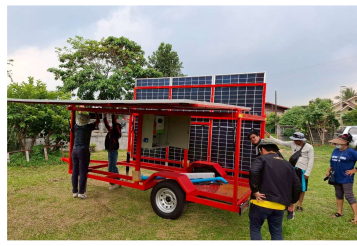
กลุ่มเกษตรกรทำสวนยางพาราร่วมใจพัฒนาตำบลโคสี จังหวัดบึงกาฬ รายการ : ระบบสูบน้ำพลังงานแสงอาทิตย์ (แบบลากจูง) ขนาดไม่น้อยกว่า 3,060 วัตต์
